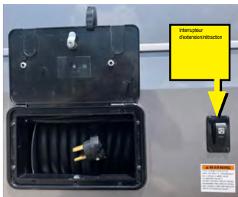
Exemple d'enrouleur de câble alimenté
