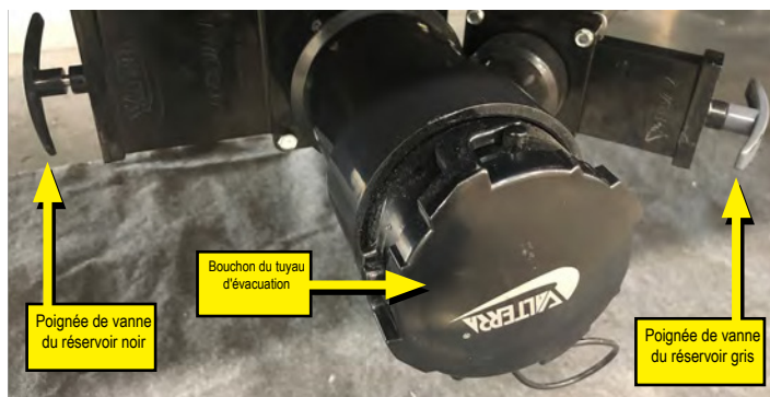
Exemple de vidange de réservoir situé sous le camping-car
